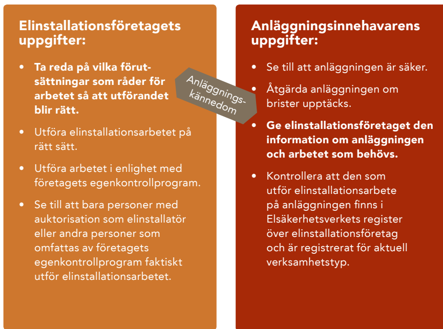
Figur 16. Anläggningsinnehavarens och elinstallationsföretagets respektive skyldigheter.
